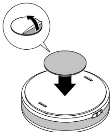
1. Odstraňte ochrannou fólii z lepicího kolečka a lepicí kolečko zatlačte pevně doprostřed zadní strany držáku na zeď.
