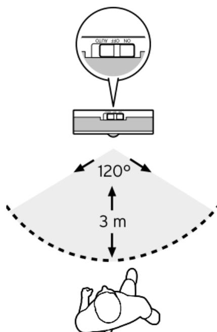
**ON** Pour allumer le luminaire de façon permanente, mettez le bouton en position **ON**.
