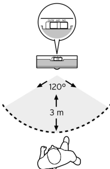
**ON** Když budete chtít svítidlo zapnout tak, aby svítilo nepřetržitě, posuňte vypínač do polohy **ON**.
